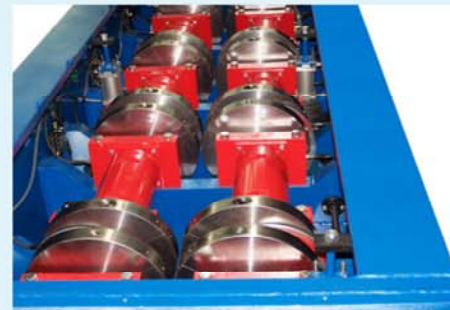
Gegenläufige Hauptwellen in Modulbauweise mit optimalem Massenausgleich und automatischer Schmierung der Lager
