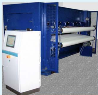
Hochleistungsnadelmaschine Baureihe 36, 1 Nadelbrett 300mm ▼
