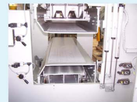
DUPLEX - Nadelzone für Keramikfasern, 2 Nadelbretter à 390mm breit
