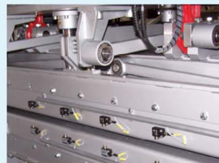
Wartungsfreie Nadelbalkenführung durch Doppellenkerpaare
